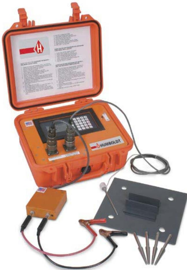
El Medidor de Densidad Eléctrico (EDG) es una alternativa no nuclear a las mediciones nucleares en la determinación de las propiedades físicas de los suelos compactados usados en las bases, sub-bases y fundaciones. El EDG es un instrumento portátil, accionado por batería que se puede usar en cualquier parte del mundo sin los problemas asociados a la seguridad nuclear.
