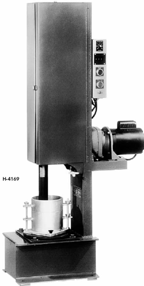
Este compactador acomoda moldes I.D. de 4" (102mm) ó 6" (152mm). El martillo redondo de 4" (102mm) ó el martillo con forma plana de 6" (152mm) compensan la caída de la muestra durante la compactación. El peso está concentrado en el extremo inferior, permitiendo la caída libre del pisón. Los cambios que se le hacen al martillo se efectúan desde la parte de adelante del compactador.
